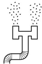
煙突は可燃物から充分離して設置し、火の粉の飛散に注意してください。
