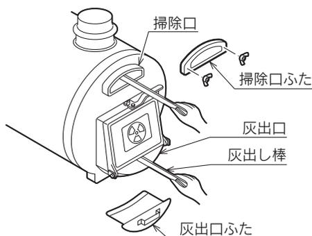
灰の取出しは完全に火が消えていることを確認してから行ってください。付属の灰出し棒で灰出口・掃除口から灰を取出してください。
