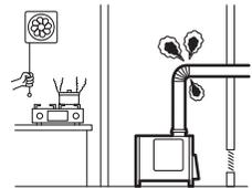
排ガスの逆流により一酸化炭素中毒のおそれがあります。風が強い日に逆流する場合は煙突の設置状況に異常がありますので使用を中止してください。
