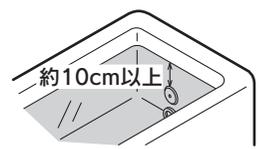
浴そうに水が入っていることを確認してください。水が入っていないと火災の原因になります。空だき防止装置はバーナーの運転を停止するもので、マキを消火することはできません。マキを燃やすときは特に注意してください。必ず上側の循環口の上部から約10cm以上給水してください。
