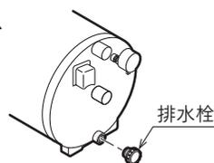
機器後面の排水栓をはずして水を抜いてください。
